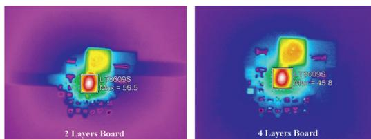
**Bild 4: Vergleich der thermischen Eigenschaften einer zwei- und einer vierlagigen Implementierung der Schaltung aus Bild 1**
