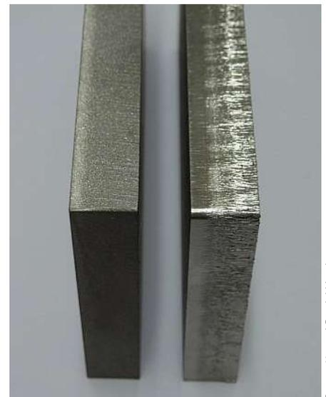
**Illustration :** Comparaison des états de surface après découpe par jet d'eau à gauche, et par laser à droite
