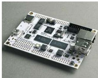
Das Entwicklungsboard VK-RZ/A1H von Vekatech (Vertrieb: Rutronik) ist mit einem Embedded-Mikroprozessor RZ/A1H von Renesas mit ARM Cortex-A9 Core für hohe Rechenleistung ausge-
