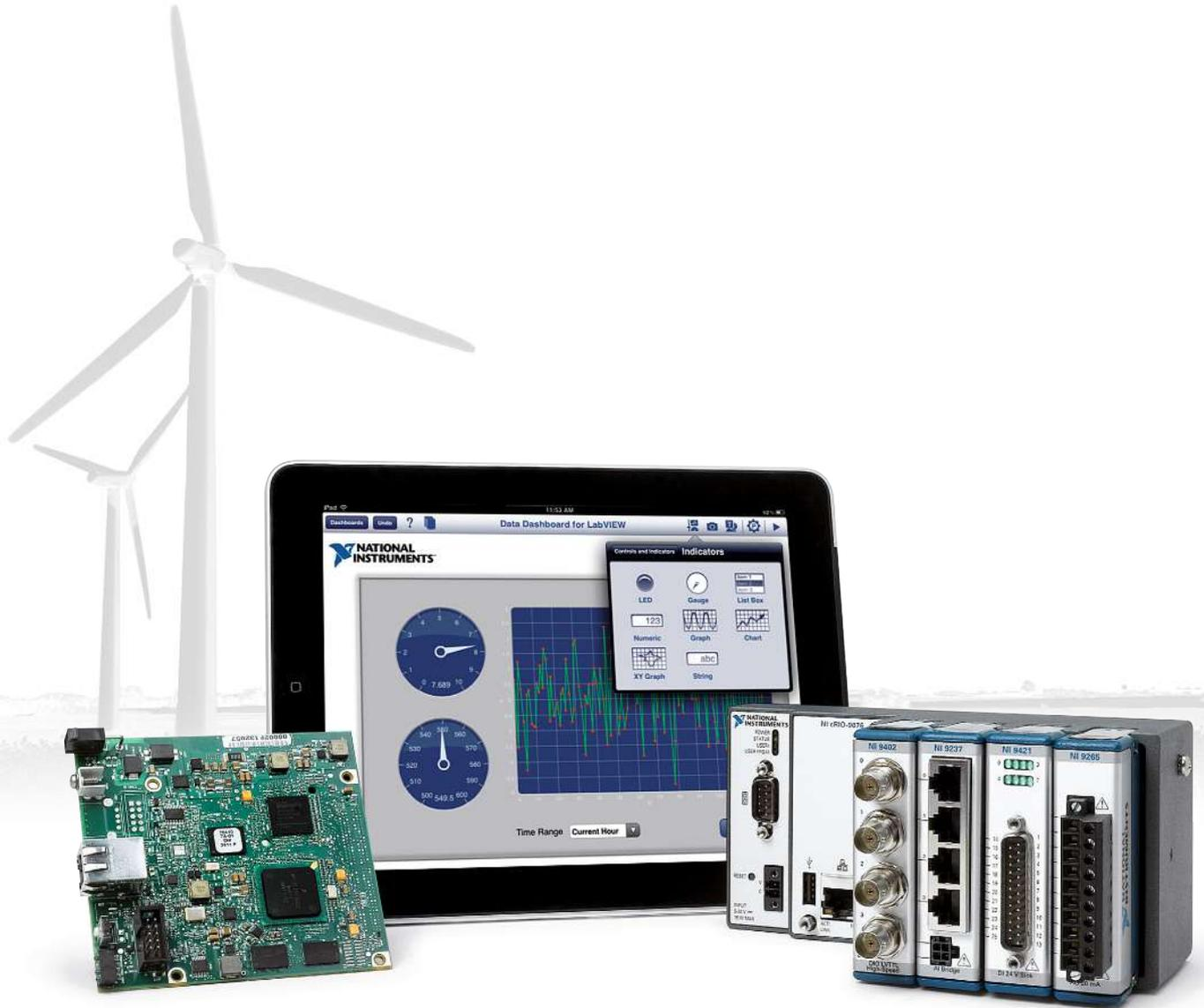
Die Kombination aus der Systemdesignsoftware NI LabVIEW und rekonfigurierbarer I/O-Hardware (RIO) unterstützt Entwicklerteams mit unterschiedlichem Expertenwissen dabei, anspruchsvolle Embedded-Anwendungen in kürzerer Zeit zu entwickeln. Mit dem Konzept des Graphical System Design kann dieselbe integrierte Plattform für das Programmieren von Embedded-Prozessoren und FPGAs eingesetzt werden.
