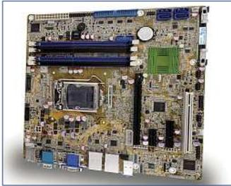
Das MicroATX Mainboard IMB-Q870-i2 von ICP bietet zusätzlich zu den PCIe x1, x4 und x16 Slots auch einen PCI Slot. Damit können auch noch etwas ältere Einsteckkarten verwendet
