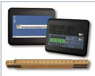
Formfaktor. Neu ist der I/O-Bus für Erweiterungen, der Flexibilität und einfache Anpassbarkeit bietet. Das lüfterlose Low-Power-Design des HMI-043T ist mit DMPs Vortex86EX-CPU bestückt und für Anwendungen in rauen Umgebungen von -20 bis 60 °C ausgelegt. Die Frontseite mit resistivem Touchscreen ist IP65-geschützt. Beiden Varianten des Standard-Produkts haben einen SD-Card-Slot sowie USB, CAN und LAN-Schnittstellen.
