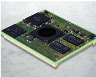
Mit dem TQMa7x und TQMa5xxx plant TQ zwei Minimodule, bei denen die neuen Prozessor-Cores ARM Cortex-A7 und Cortex-A15 zum Einsatz kommen. Beim TQMa7x wird ein optimierter ARM
