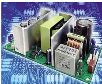
RECOMs neue Open-Frame-Class-II-Netzteile haben eine Ausgangsleistung von 48 W (RAC48/OF) bzw. 60 W (RAC60/OF). Die Module mit den Maßen 2" x 4" arbeiten mit einem Wir-
