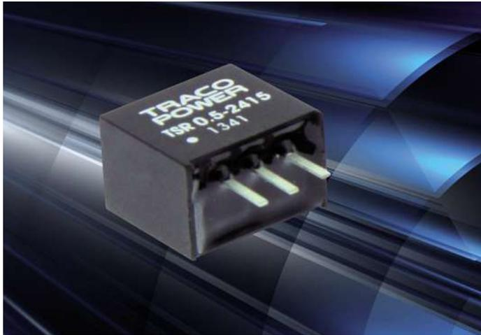
Mit den Schaltreglern der Serie TSR-0.5 erweitert Traco Power sein Angebot nicht galvanisch getrennter Abwärtsregler. Diese Konverter eignen sich bestens als Ersatz für LM78-Linearregler, wenn Energieeffizienz ein wichtiger Designparameter ist. Der hohe Wirkungsgrad von bis zu 97% ermöglicht den Betrieb bei Volllast und 80 °C Umgebungstemperatur. Bei 50% Belastung sind maximal 90 °C möglich.
