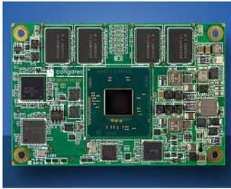
Mit dem conga-MA3 bietet Data Modul die Intel-Atom-Prozessorgeneration auch im COM-Express Mini-Modul-Format. Es bietet die doppelte Leistung zum Vorgänger und mit Keramik Kondensatoren eine optimierte Lebensdauer. Beim Pinout-Typ 10 handelt es sich um eine Aktualisierung des Typ 1.
