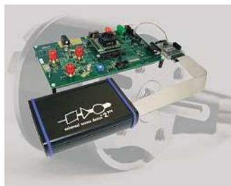
Ein Test- und Debug-Werkzeug für die Embedded-Power-IC-Serien TLE986x und TLE987x von Infineon bietet PLS mit der Version 4.3.4 seiner Universal Debug Engine (UDE). Die Embedded-
