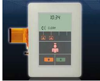
Das Optical Bonding bietet für die Medizinbranche Vorteile. Durch das flächige Verkleben des Displays und das mit oder ohne kapazitiven Touch, garantiert eine schmutzkantenfreie Gerätefront. Die Blende (Cover Lens) lässt sich bis an die Ränder des Geräts führen. Reinigungsmittel schädigen nicht die Elektronik und die harte Oberfläche bleibt kratzfrei. Densitron bietet hierzu vielfältige Lösungen bei seinen Displays. Im Prinzip kann jede Displaytechnik, die von Densitron
