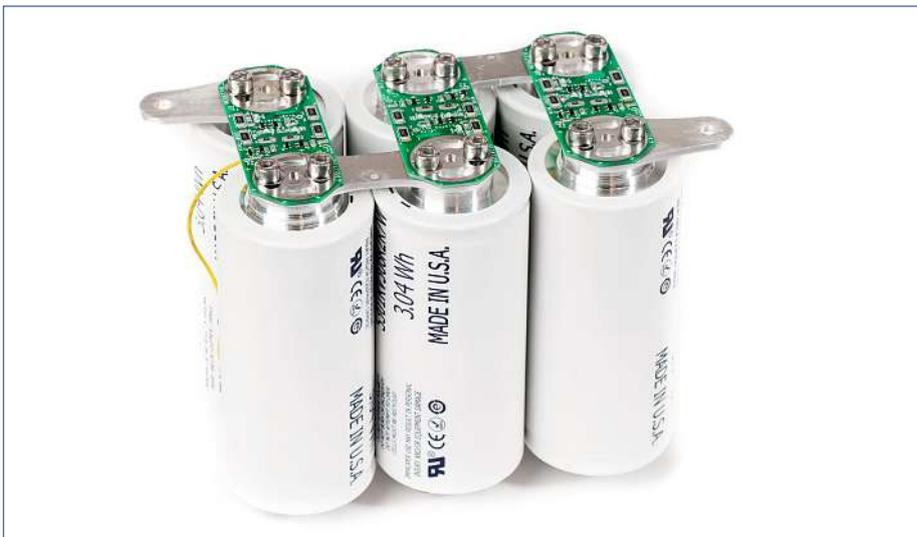
**Bild 4:** Superkondensatoren in einem 6-Zellen-Modul mit zweistufigem, aktivem Ausgleich
