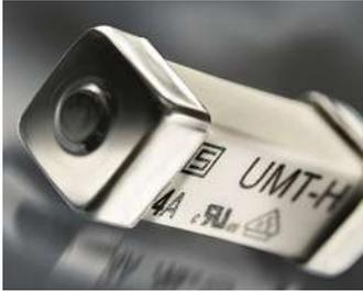
Die SMD-Sicherung UMT-H von Schurter hat jetzt zusätzlich zur cURus- auch die VDE-Zulassung. Die träge Sicherung bietet Überstrom- und Kurzschlusschutz für industrielle Sicherheitsanwendungen sowie elektrisch eigensichere Anwendungen. Das Ausschaltvermögen von 1500 A, der Kappenabstand von >10 mm und die Vergussfähigkeit ermöglichen Anwendungen im Bereich des Explosionsschutzes. Die Si-
