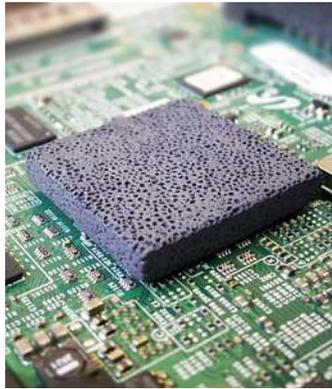
len eingehen zu müssen. Folglich erhöht sich die Zuverlässigkeit als auch die Lebensdauer des Systems; das Ausfallrisiko sinkt. Tests haben ergeben, dass die Kühlkörper vergleichbare Lösungen anderer Hersteller um bis zu 6 °C/W übertreffen. Bei einer Last von 5 W beträgt der Wärmewiderstand des Kühlkörpers LPH0010 17,4 °C/W.
