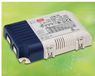
Für LED-Lichtsteuerungen bietet Emtron die Stromversorgungsfamilie LCM-25 (DA) von Mean Well mit einer Ausgangsleistung von 25 W. Das Gerät ist als Konstantstromquelle mit mehrstufiger Regelung ausgeführt; der Ausgangsstrom lässt sich per DIP-Schalter einstellen. Erhältlich ist die Stromversorgung als Basis-
