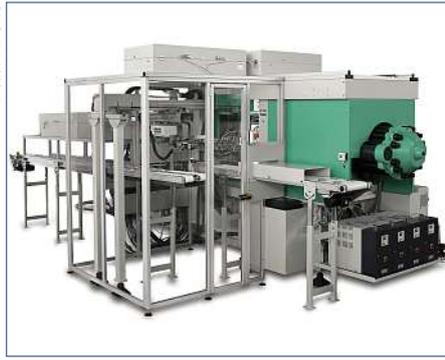
**Spritzgießtechnik:** Das Spritzprägewerkzeug für LED-Vorsatzoptiken (links) und eine Spritzgießmaschine.
