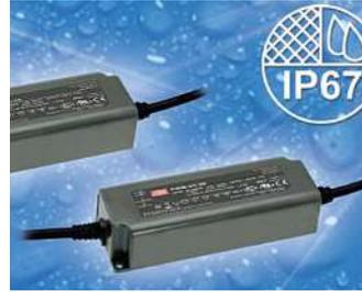
Bereits nach der Einführung des 90-Watt-Modells der PWM-Serie erweitert der Netzteile-Hersteller Mean Well (Vertrieb: M+R Multitronik) das Lieferportfolio um LED-Treiber mit Leistungen von 40 und 60 W. Die Netzteile bieten zudem eine optionale PWM-Dimmfunktion. Der weite Eingangsbereich reicht von 90 bis 305  $V_{AC}$  mit aktiver Powerfaktorkorrektur (PFC). Damit lassen sich die Treiber der PWM40- und PWM60-Serie weltweit einsetzen. Zudem wurde die Serie mit
