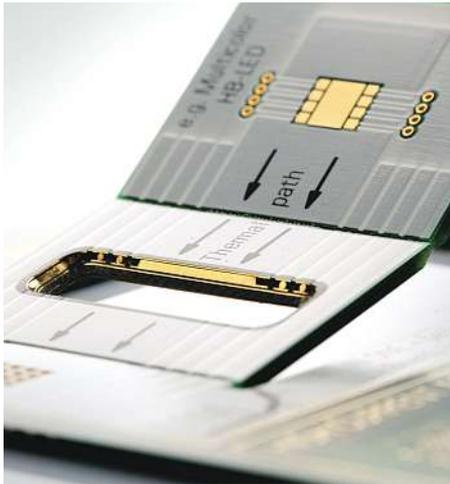
mit Thermovias sowie mit Metallkern- und Keramik-Leiterplatten verglichen. Getestet wurde mit zwei Leiterplatten, die mit den leuchtstarken LED-Typen Ostar mit bis zu 12 W und Oslon mit bis zu 3 W bestückt waren. Beim Temperaturzyklustest von -40 bis 85 °C fielen bei den Metallkernleiterplatten auf Aluminiumbasis bereits nach 850 Temperaturzyklen Lötstellen aus, verursacht durch die unterschiedlichen thermischen Ausdehnungen des LED-Substrates (Keramik) und der Leiterplatte.
