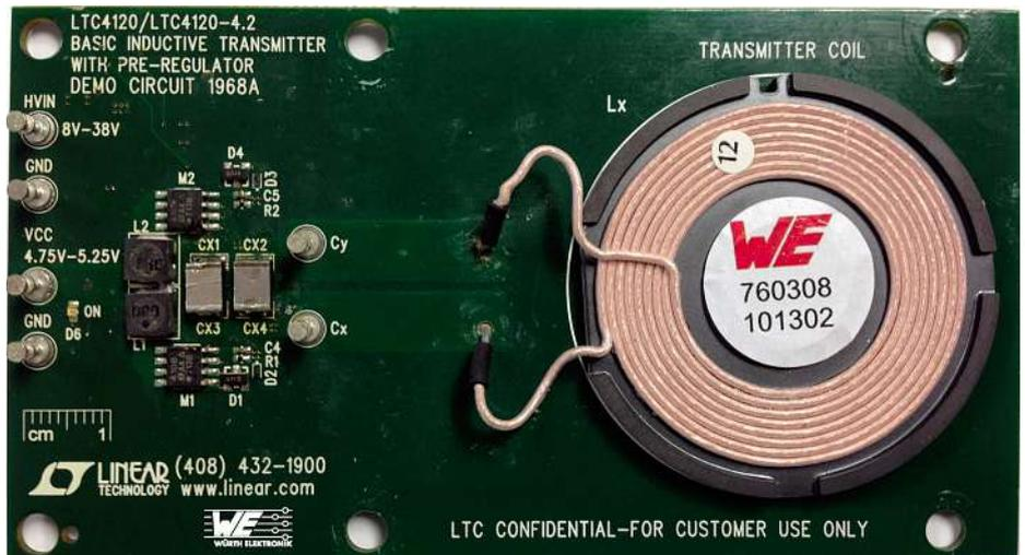
Bild 1: DC1968A, Demo-Sendekarte mit WE-Senderspule 760 308 101 302
