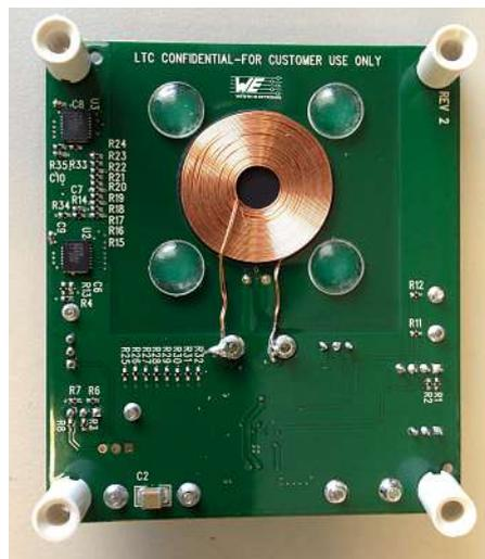
**Bild 2:** DC1967A, Demo-Empfängerkarte mit WE-Empfängerspule 760 308 101 303
