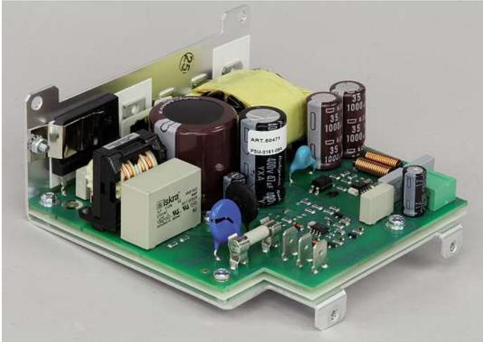
Bild 3: Montageplatte als diskreter Kühlwinkel
