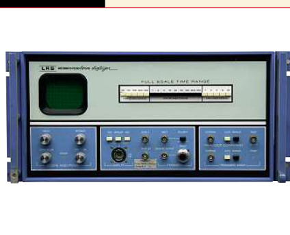
WD 2000: Ausgestattet mit einem Echtzeit A/D-Wandler, Speicher und Display in einem Gerät.
