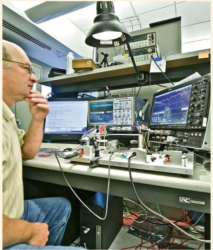
Bei der Arbeit: Mit den aktuellen Geräten von Teledyne LeCroy lassen sich bis zu 240 GS/s abtasten und sie bieten eine Echtzeitbandbreite von 100 GHz.
