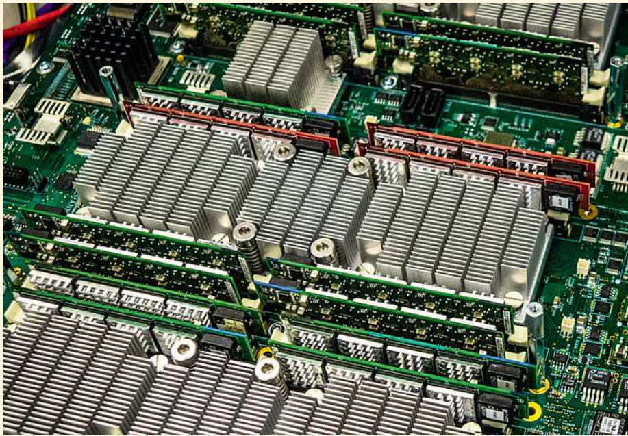
LabMaster 10Zi: Das Board zur Datenerfassung erfasst mit vier analogen Kanälen 36 GHz mit 80 GS/s. Verbaut ist ein Silizium-Germanium-Frontend-Verstärker.
