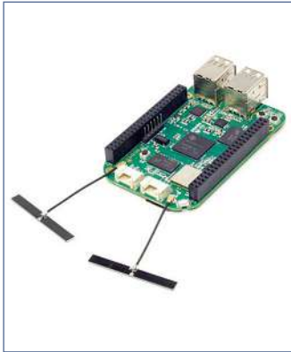
BeagleBone Green Wireless: Das erste BeagleBone-Board mit Funkschnittstellen
