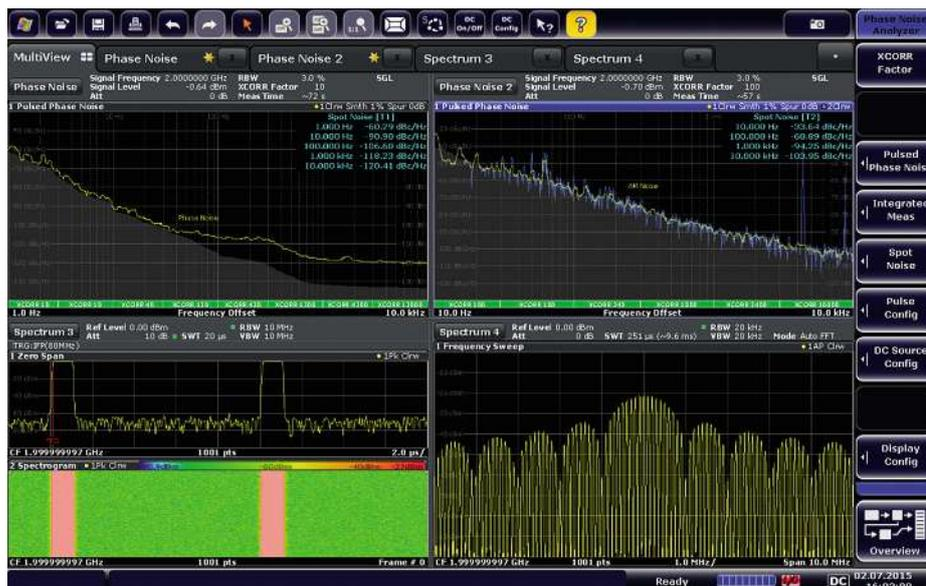
**Bild 2:** Messung eines gepulsten Signals mit dem Phasenrauschanalysator (oben) sowie mit dem Spektrumanalysator im Zeit- und Frequenzbereich (unten). Das Fenster oben links zeigt das Phasenrauschen eines gepulsten Signals mit Kreuzkorrelationsfaktor 10 (grauer Bereich). Oben rechts ist das Amplitudenrauschen des Signals angezeigt, diesmal mit XCORR-Faktor 100. Der graue Bereich zeigt den Empfindlichkeitsgewinn durch Kreuzkorrelation an.
