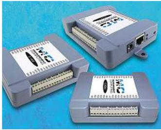
Das Thermoelement-Messmodul E-TC mit acht Kanälen und einem 24 Bit A/D-Wandler von Data Translation ermöglicht es, Sensoren der Typen J, K, R, S, T, N, E und B direkt anzuschließen und verfügt über eine Kaltstellenkompensation. Die Anschlüsse sind gegenüber dem Host isoliert, ein Kabelbruch des Thermoelements wird automatisch erkannt. Die maximale Abtastrate beträgt 4 S/s pro Kanal.
