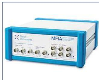
Der MFIA Impedanzanalysator von Zurich Instruments misst Impedanzen von 1 mOhm bis 10 GOhm bei Frequenzen von 1 Hz bis 5 MHz. Messungen bei DC sind ebenfalls möglich. Es lässt
