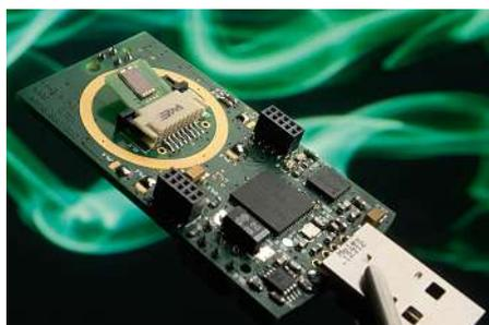
**Bild 1:** USB-Stick mit Sensorbauelement, um Feuchte und Kohlendioxid zu messen.
