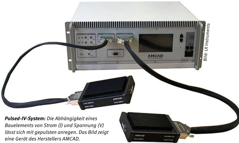
**Pulsed-IV-System:** Die Abhängigkeit eines Bauelements von Strom ( $I$ ) und Spannung ( $V$ ) lässt sich mit gepulsten anregen. Das Bild zeigt eine Gerät des Herstellers AMCAD.
