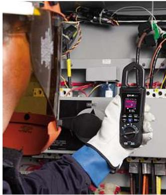
Messung zu vereinfachen und um Fehler und Anomalien aufzuspüren und zu beseitigen, gehören Echteffektivwert, LoZ, VFD-Modus, Anlaufstrom oder der Dioden-/ Halbleitertest mit abschaltbarer automatischer Polaritätsumkehr.
