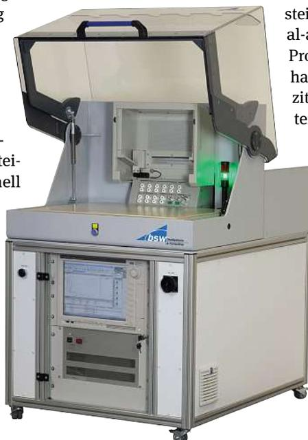
**Testsystem:** Das Bild zeigt eine erweiterte Arbeitsfläche und eine Sicherheitshaube für 10 kV inkl. einer Sicherheitschaltung der bsw.
