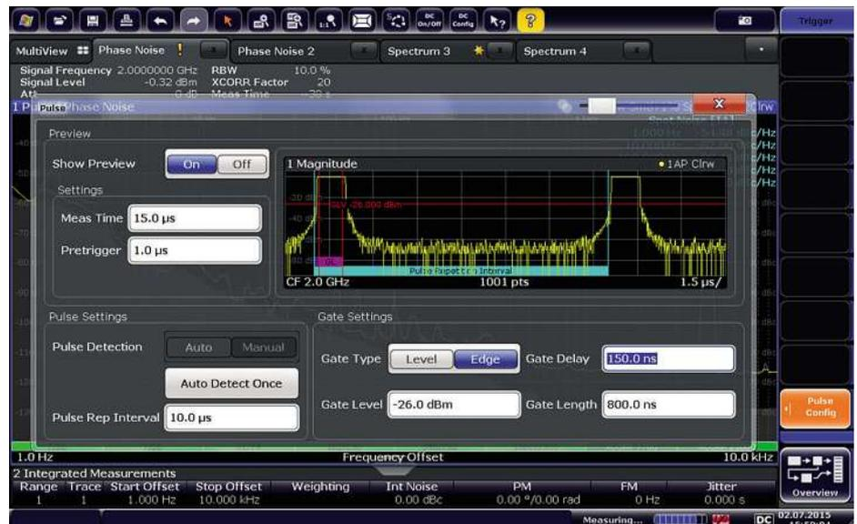
**Bild 3:** Die Pulsparameter werden zwar automatisch vermessen, den Anwendern steht es trotzdem frei, Messbereiche (Gates) selbst zu definieren.
