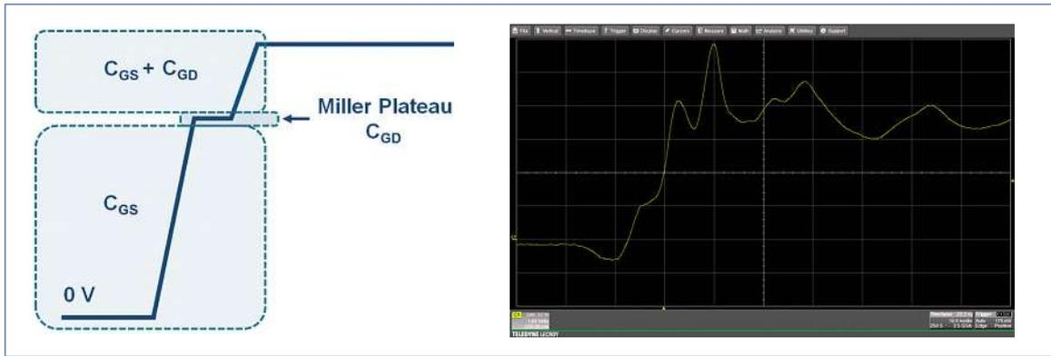
**Bild 2:** Vergleich des mit dem DA1855A von Teledyne LeCroy ermittelten High-Side-VGS-Werts mit dem idealen Signal.
