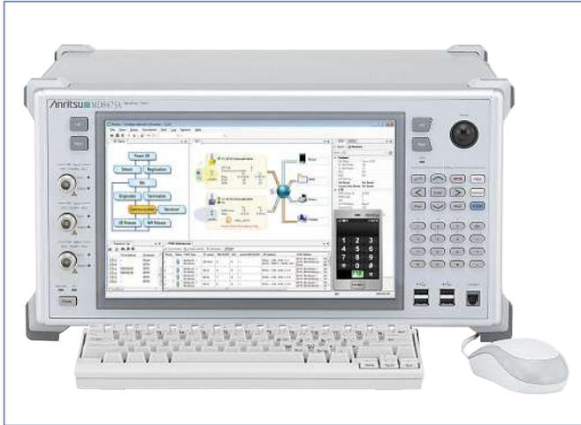
**Bild 2:** Der MD8475A von Anritsu unterstützt alle Mobilfunkprotokolle, bis hin zu LTE-Advanced; auch zum Testen von eCall-Systemen lässt sich das Gerät verwenden.
