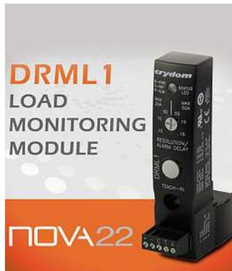
derseite oder über den externen „Teach-In“-Eingang festgelegt. Das Modul ermöglicht die Auswahl des max. Stromwerts von 20 oder 50 A, erkennt Teillasten ab 150 mA und bietet eine konfigurierbare Verzögerung für die Alarmrauslösung (0,1 s, 1 s oder 5 s), die über einen Parameter-Wahlschalter eingestellt werden kann.
