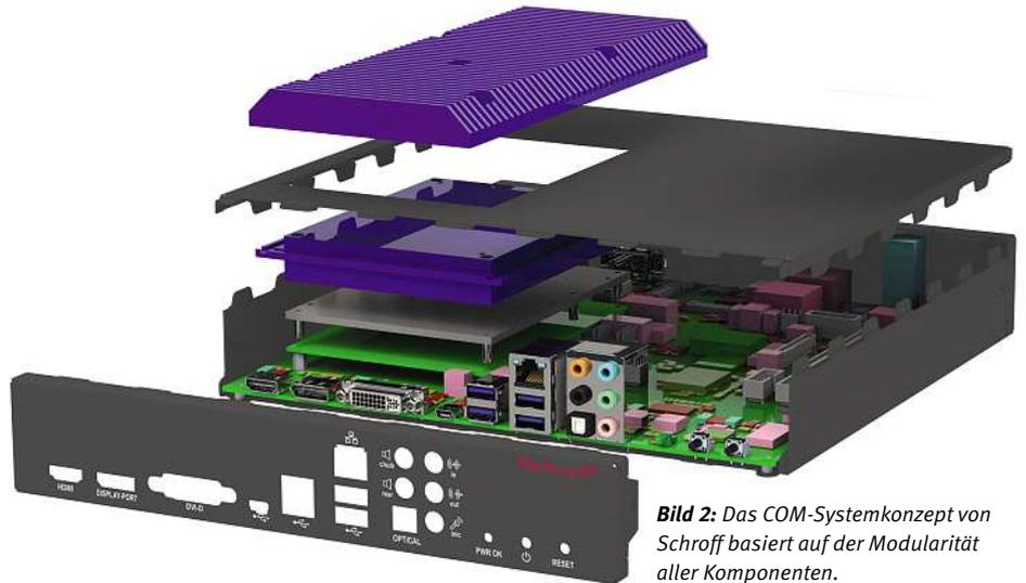
**Bild 2:** Das COM-Systemkonzept von Schroff basiert auf der Modularität aller Komponenten.
