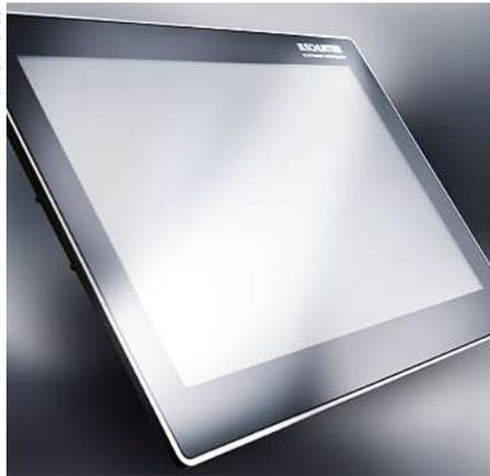
**Entspiegeltes Frontglas:** Ein PCI-Multitouch-Panel mit 22" wird speziell für dein Einsatz in der Industrie mit einem 3 mm dicken Frontglas ausgestattet. Damit solch ein Display geeignet ist, muss es EMV beständig sein, es darf kein Wasser eindringen und muss sich mit Handschuhen bedienen lassen.
