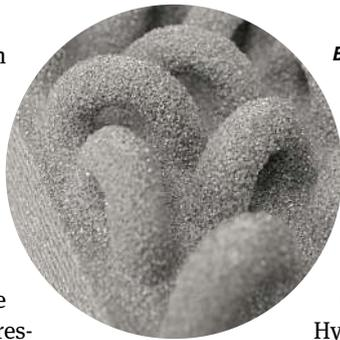
**Bild 3:** Der Wärmetauscher, beschichtet mit Adsorbens
