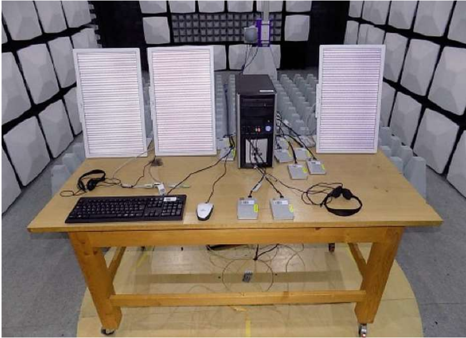
EMV-Test: Spezifikationen wie die EN 61000-6 erfordern Tests der elektromagnetischen Verträglichkeit von Industrie-PCs und ihrer Komponenten.
