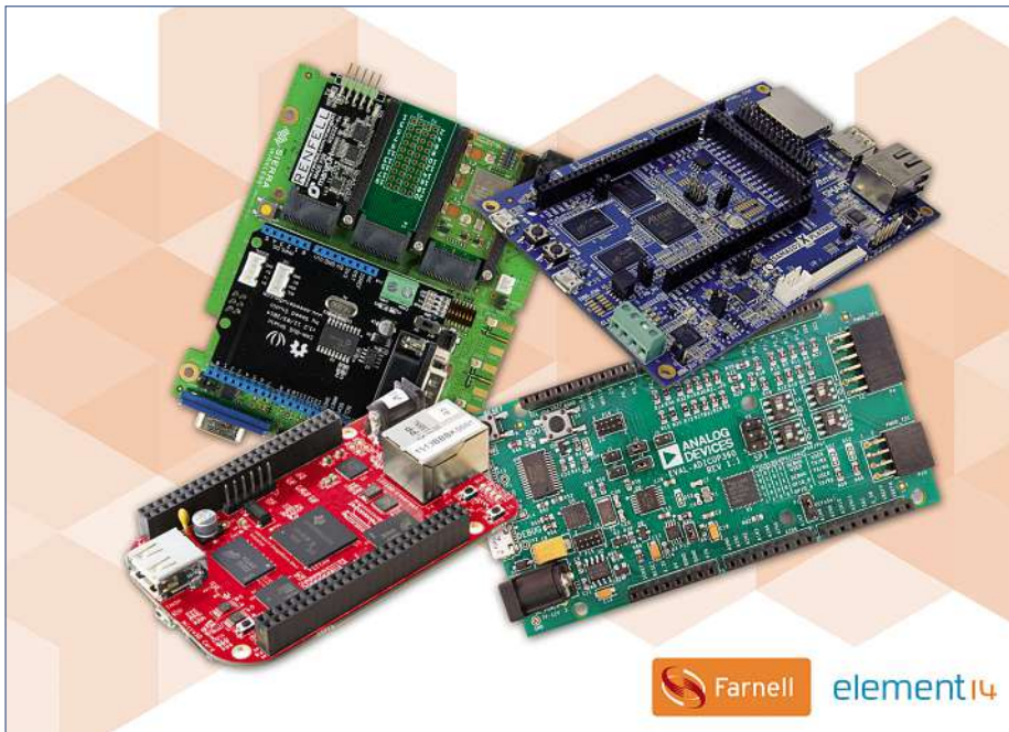
Platinenvielfalt (im Urzeigersinn): BeagleBone Black Industrial (rot) für Temperaturen von -40 °C bis 85 °C; Sierra Wireless mangOH Green. Microchip Sama5D2-XULT und das Arduino-kompatible EVAL-ADICUP360
