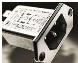
dard und Medizintechnik M5- oder M80-Version erhältlich. Standardmäßig sind Kondensatoren der Klasse X2 und Y2 verbaut. Für erhöhte Stoßspannungsanforderungen sind Varianten mit Kondensatoren der Klasse X1 und Y1 erhältlich. Die Serie ist auch als Schutzklasse-II-Ausführung erhältlich, für Geräte ohne Schutzleiteranschluss nach IEC 61140. Der EMV-Filter befindet sich an der Stromzuführung am Netzeingang.
