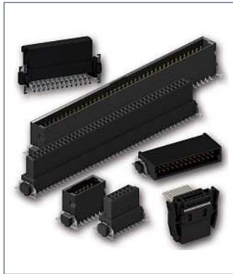
auf die Leiterplatte führen. Die IDC-Federleiste ist in den Polzahlen 12, 16, 20, 26, 32, 40, 50, 68 und 80 erhältlich. Die Koplana-ritätstoleranz beträgt 0,1 mm. Seitliche Metallwinkel, so genannte Boardlocks, die ebenfalls auf der Leiterplatte verlötet werden, sorgen für extreme Belastbarkeit der Verbindung zwischen Steckverbinder und Leiterplatte.
