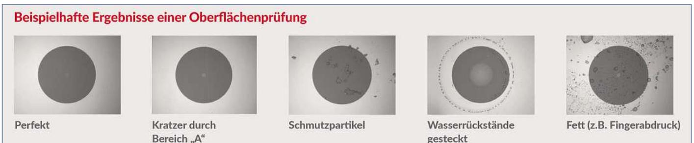
Bild 4: So unterschiedlich kann die Kontaktfläche von Glasfasern aussehen. Von links: gereinigte Verbindung, Wasserrückstände, Staub- und Schmutzpartikel, Fingerabdruck.
