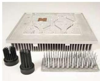
Hochdruckguss-(HDDC)-Kühlkörper von Aavid haben Vorteile gegenüber bearbeiteten, Druckguss- oder extrudierten Kühlkörpern. Die höhere thermische Leitfähigkeit gekoppelt mit vielfältigeren Möglichkeiten bei Lamellenkonfiguration, -Dicke und -Form sind Vorzüge z.B. bei stiftförmigen, elliptischen oder radi-
