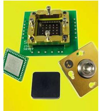
nale werden bis zu 75 GHz mit weniger als 1dB Verlust übertragen. Die Messergebnisse sind direkt vergleichbar mit den Ergebnissen des aufgelöteten IC. Der Interposer steht für Rastermaße von 0,3 bis 1,27 mm zur Verfügung. 1000 Wechselzyklen sind spezifiziert, so dass der Sockel für den Laborbetrieb ideal ist.
