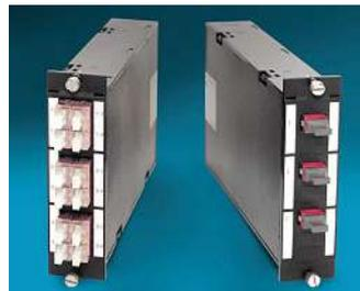
Mit den FO-DCS Speed-Konverter-Moduleinschüben von Dätwyler lassen sich alle bekannten Multimode- und Singlemode-QSFP-Anwendungen wie SR4, PSM4, PLR4 und FCp in vier Duplex-Kanäle konvertieren. Die Connectivity dieser Moduleinschübe trennt die drei ankommenden Paralleloptik-Links in je
