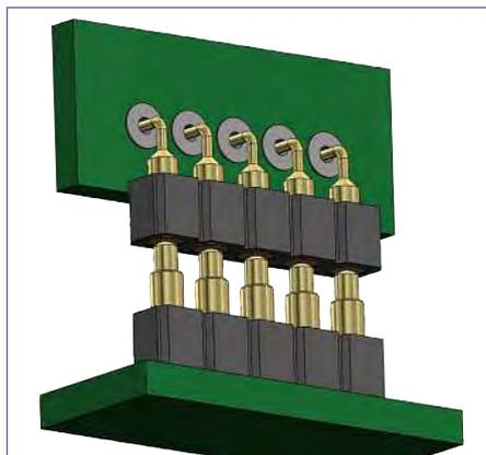
**Bild 2:** Typische rechtwinklige Leiterplattenverbindung mit Federkontakten.
