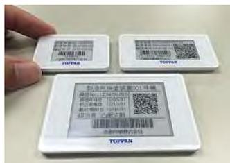
eines NFC-Lese-/Schreib-Geräts gleichzeitig aktualisieren. Der Baustein mit seiner extrem geringen Verlustleistung enthält keine Batterie und arbeitet einfach mit Energy Harvesting, die ausschließlich dem RFID-Reader/-
