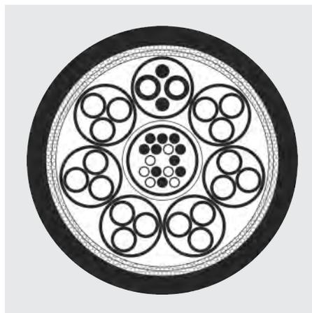
**Bild 1:** Querschnitt des CAN-Bus High-Endurance Kabels.
