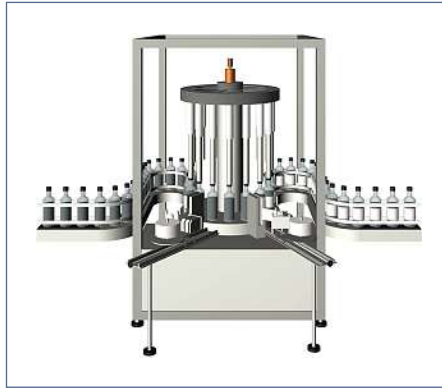
Bild 4: Die Etikettierstation einer automatisierten Abfüllanlage.
