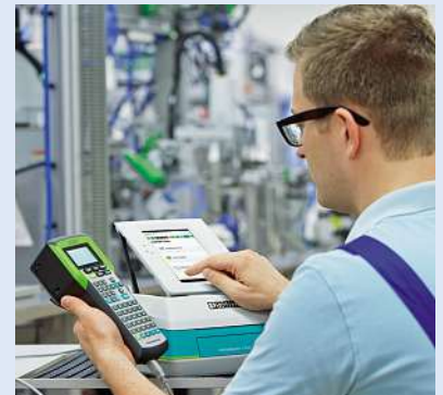
Bild: Über den mobilen ThermoTransfer-Kartendrucker Thermomark Prime (rechts) lässt sich der Handheld-Drucker Thermofox auch per USB-Verbindung ansteuern.
