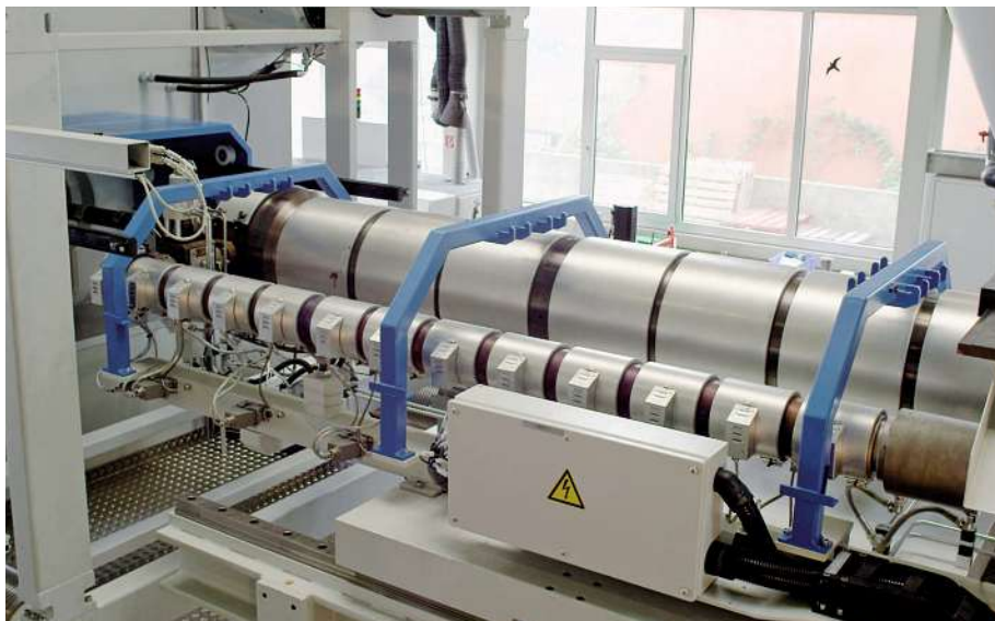
Bild 4: Maßgeschneidert zur Produktion von Formteilen der obersten Volumen- und Gewichtsklasse mit langen Kühlzeiten, kann die Anlage mit einer sequenziellen Bewegungsfolge betrieben werden. Dies ermöglicht ein 1-Pumpen-Layout für die Hydraulikanlage.
