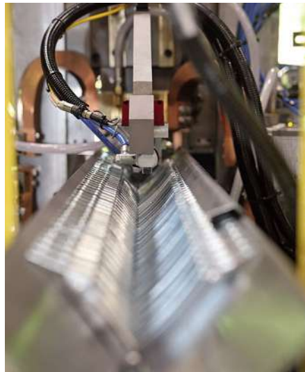
Bild 3: Von der Rückseite der Maschine werden vorgefertigte Verschlüsse vereinzelt und für die Verschweißung am Ring zugeleitet.
