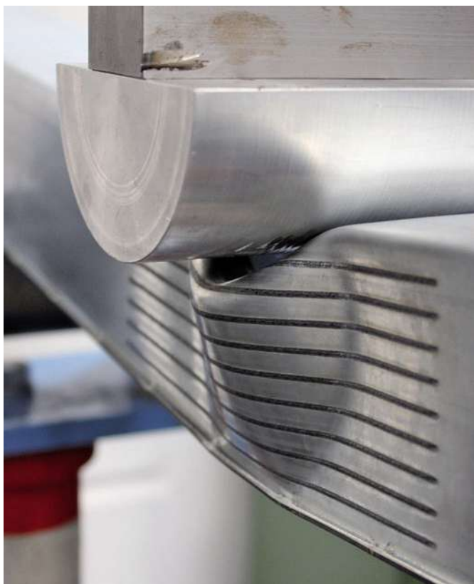
Bild 1: Eigenschaften von Karosseriebauteilen lassen sich durch eine Laserverfestigung verbessern: Im Crashtest wird geprüft, wie stark das Beispielbauteil unter einer Biegebelastung deformiert wird.
