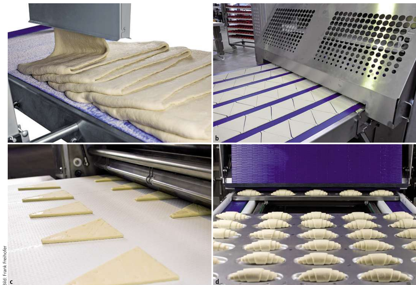
Bild 2: Alle Bearbeitungsschritte, vom Laminieren des Teigs (a) über das Stanzen (b), Drehen und Vereinzeln (c) bis zur Übergabe der fertigen Teiglinge auf Backbleche (d), zählen zu den Kernkompetenzen der Unterfranken.
