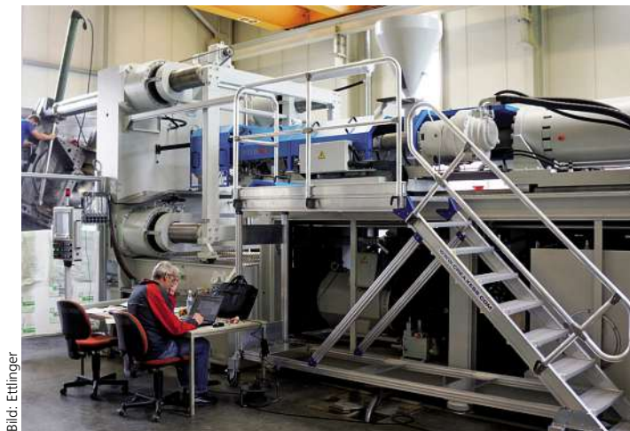
Bild 3: Groß-Spritzgießmaschinen des Typs Ettliger srm 2000/130 kombinieren eine Vierholm-Zweiplatten-Schließeinheit mit einer Zweistufen-Plastifizier-/Spritzeinheit.
