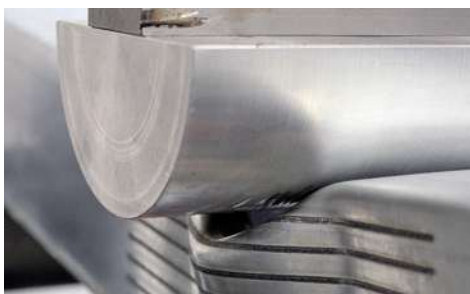
► Umformtechnik: Eigenschaften von Karosseriebauteilen lassen sich durch eine Laserverfestigung verbessern. 34
