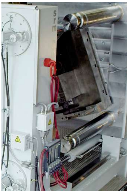
Bild 5: Bei vollem Öffnungshub können Spritzgießwerkzeuge ohne die Einschränkungen durch die Holme sowohl von oben als auch seitlich ein- und ausgebaut werden.
