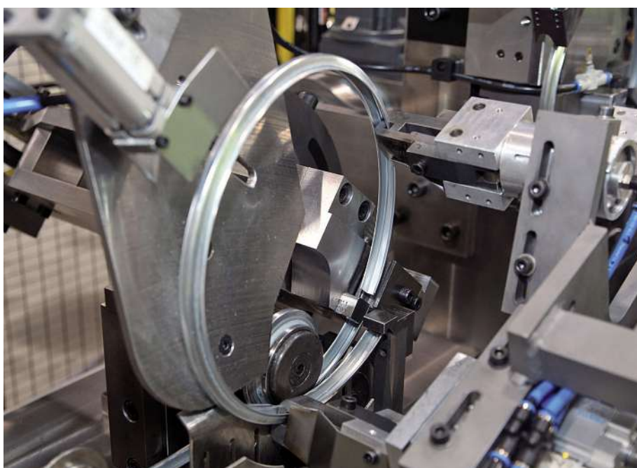
Bild 1: In der Biegestation formt der Servo-Spannringautomat Durchmesser und Drall des Stahlringverschlusses.
