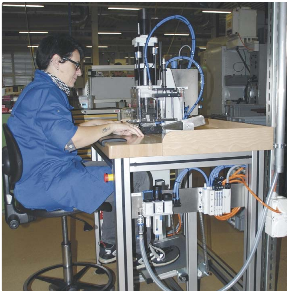
Un poste de travail doté d'une presse pneumatique Schmidt Technology.
