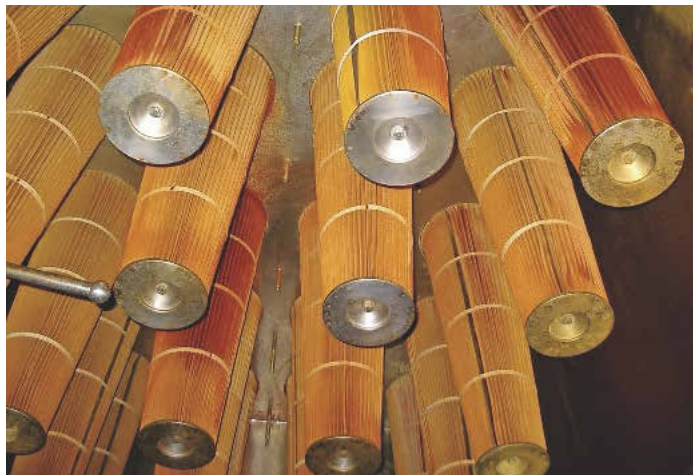
Die Patronenfilter werden zum Reinigen ausgebaut. Für die sichere Reinigung der Anlage sorgt ein integriertes Waschdüsen-system.
