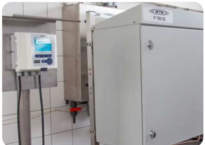
System 282/284 mit Phosphat-Analyser P 700 IQ
