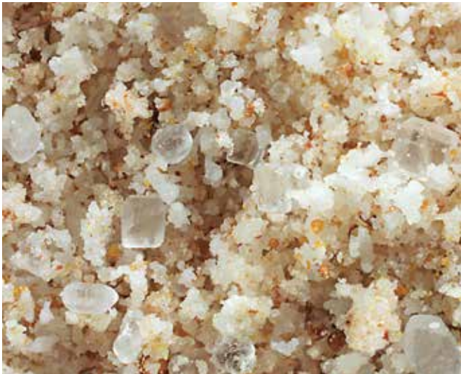
Chai Latte: Sprühagglomeration verbessert die Instant-Eigenschaften. Staubfreie Partikel mit poröser Struktur lassen sich besser dosieren, benetzen und auflösen.
