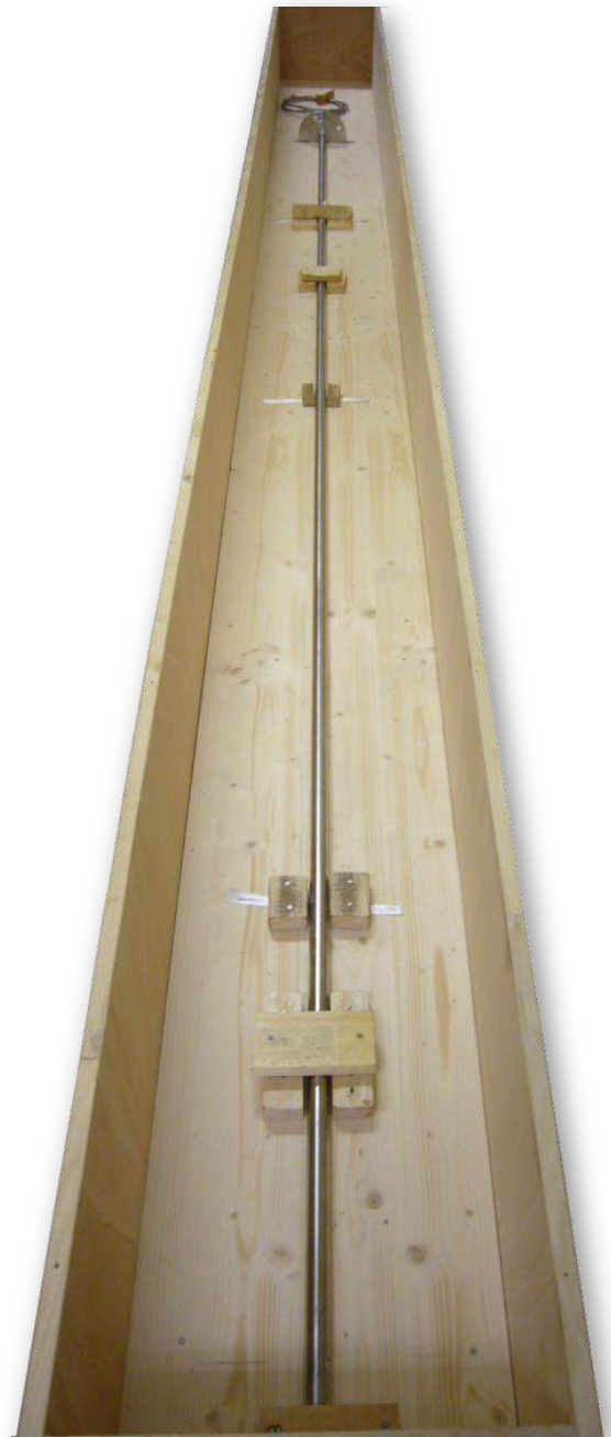
Bild 1: Versandfertige Sonde 661-971-2-NIR-85 mit vier Meter Eintauchtiefe für die Kontrolle hochtoxischer Chemikalien in einem Erd-Tank
