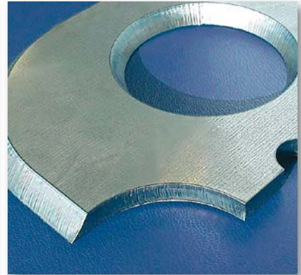
Beispiel: V-Innenkante 30° V-Außenkante 40° Material: Baustahl 8 mm
