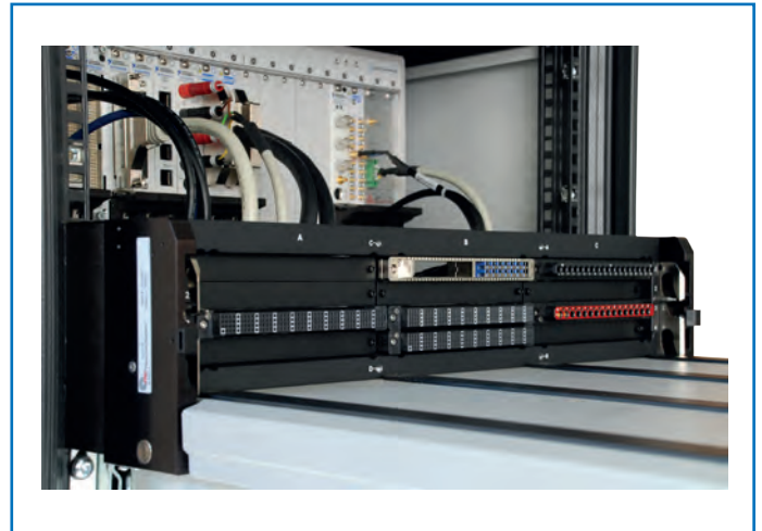
Bild 8: VPX F12 Adapterinterface
