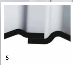
Überlappnaht konstruktiv (5) und im Schnitt (6).
