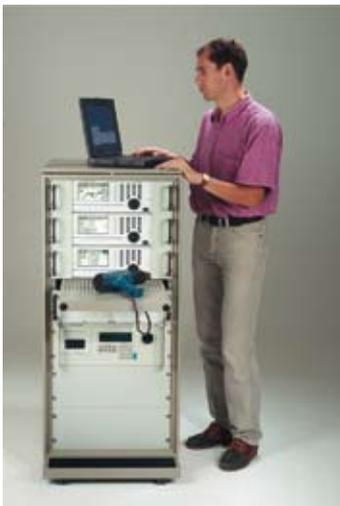
Das LMG95 wird als Analysator in CE-Prüfsystemen zur Überprüfung der Netzrückwirkungen durch Stromoverschwingungen und Flicker eingesetzt. Nebenstehende Abbildung zeigt das ZES ZIMMER Prüfsystem SYS61K mit drei Geräten LMG95 für ein- und dreiphasige Anwendungen.
