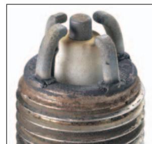
Eine Ultra X-Zündkerze, ausgewechselt im Rahmen der Inspektion: Der Isolatorfuß ist frei von Ablagerungen, sowohl Masse- als auch Mittelelektrode weisen nur einen geringen Abbrand auf.
