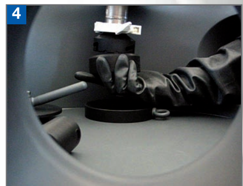
4 Entfernen des Sauglanzen-Schutzdeckels vor dessen Einführung
