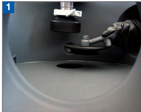
1 Entfernen des Schutzdeckels und Zugang ins Innere des DCS
