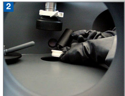
2 Entfernen der Schraubklappe mit einem speziell entwickelten Werkzeug zur Öffnung des Fasses
