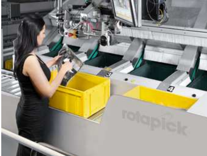
Hochleistungskommissionierung mit psb rotapick (Arbeitsstation bei der Firma Next Distribution, England) (Bild: psb intralogistics GmbH)
