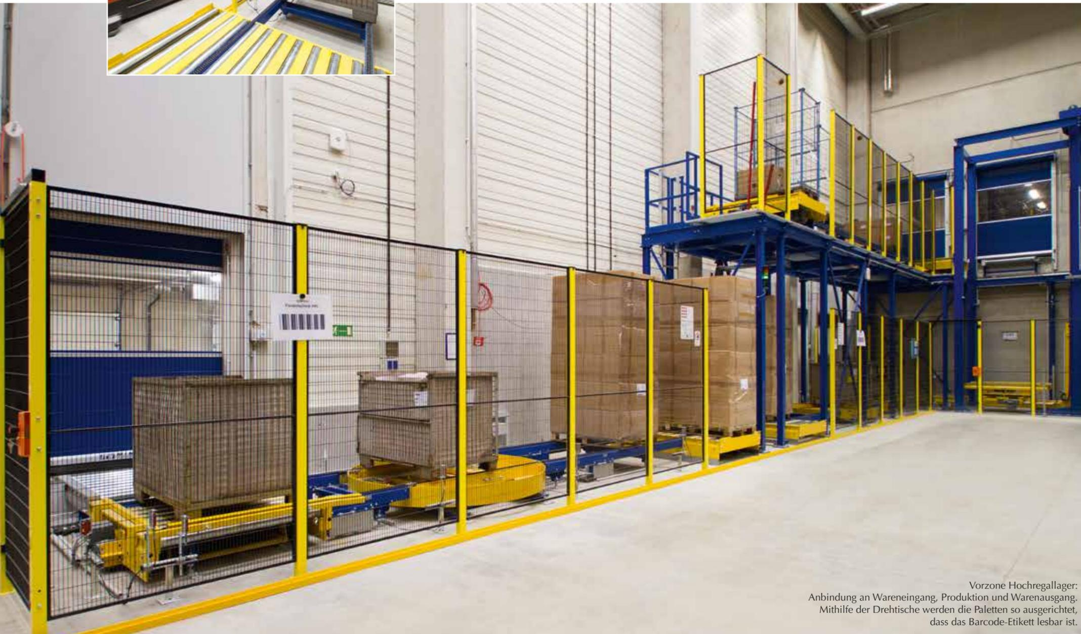
Vorzone Hochregallager: Anbindung an Wareneingang, Produktion und Warenausgang. Mithilfe der Drehtische werden die Paletten so ausgerichtet, dass das Barcode-Etikett lesbar ist.
