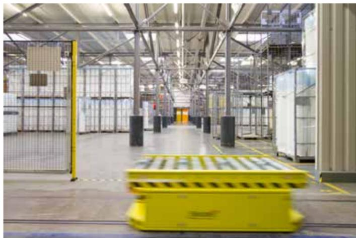
Dank des induktiv angetriebenen Verfahrwagens bleibt bei Jokey Plastik in Wipperfürth die Durchfahrt für den Staplerverkehr frei.
