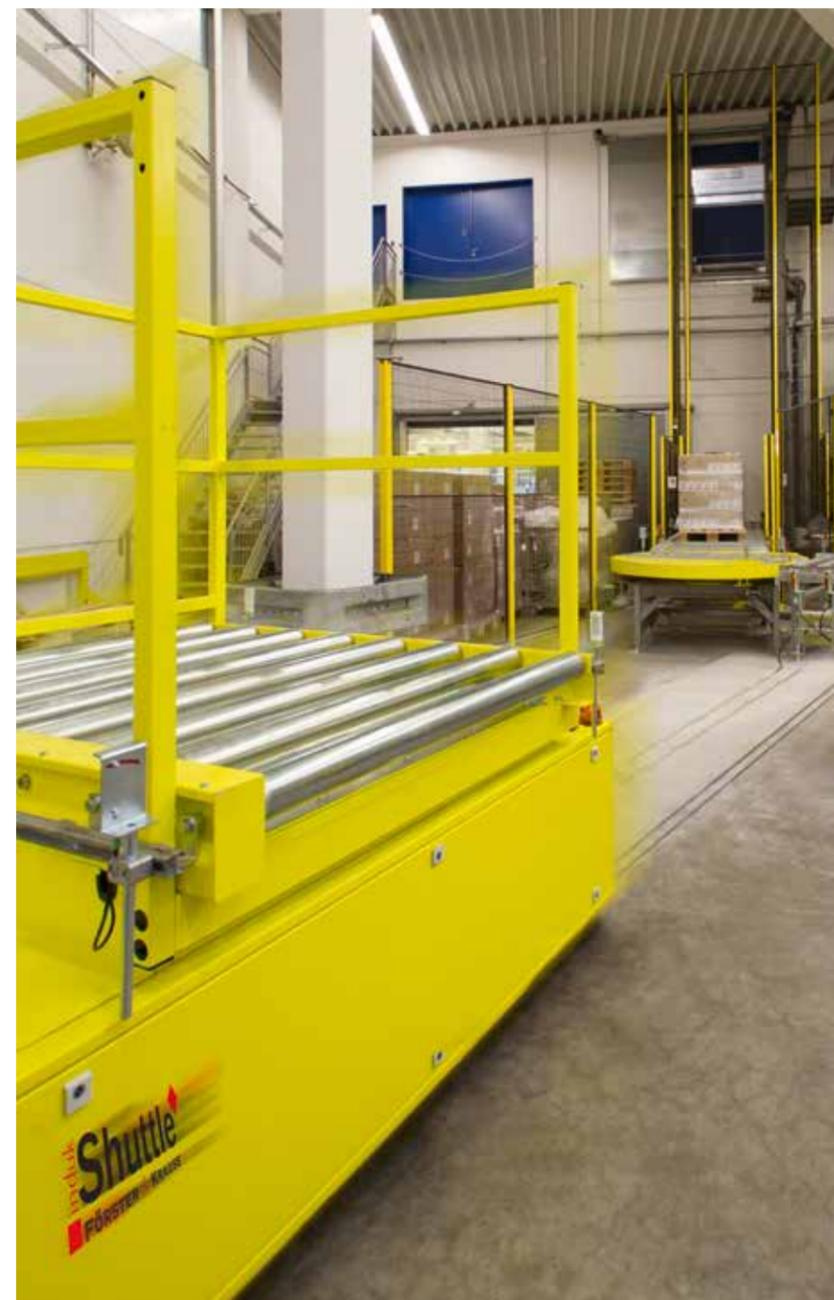
Bereits 2010 wurde die fördertechnische Verbindung von der Produktion im 1.OG zum Lager installiert (Foto unten). Diese wurde nun um eine Förderstrecke mit Drehtisch erweitert: So kann der induktiv angetriebene Transferwagen die Paletten abnehmen und sie zu einem der vier Lagerbereiche im Neubau fördern.
