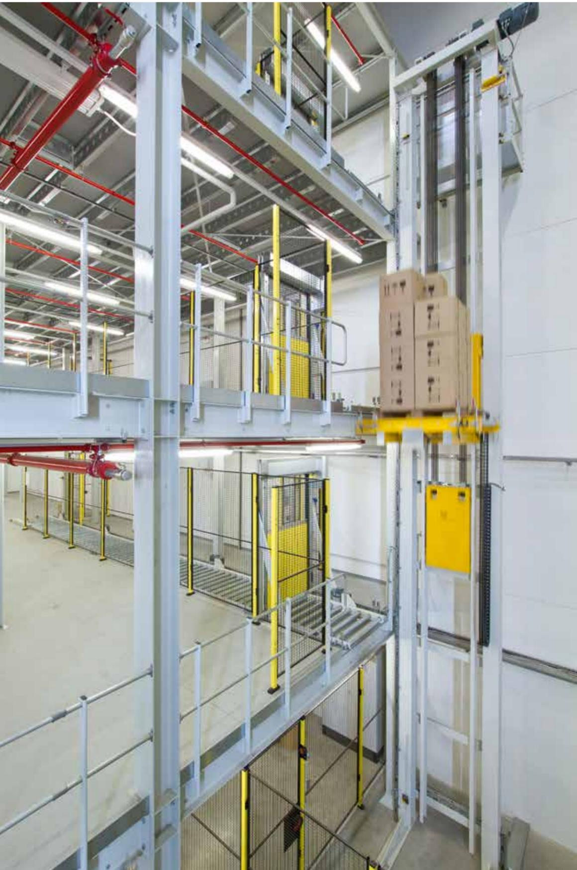
Die vier Ebenen, auf denen Kartons von den Paletten aus dem Durchlaufregal beleglos abkommissioniert werden, sind automatisch über einen Senkrechtförderer an die Hauptförderstrecke angebunden.
