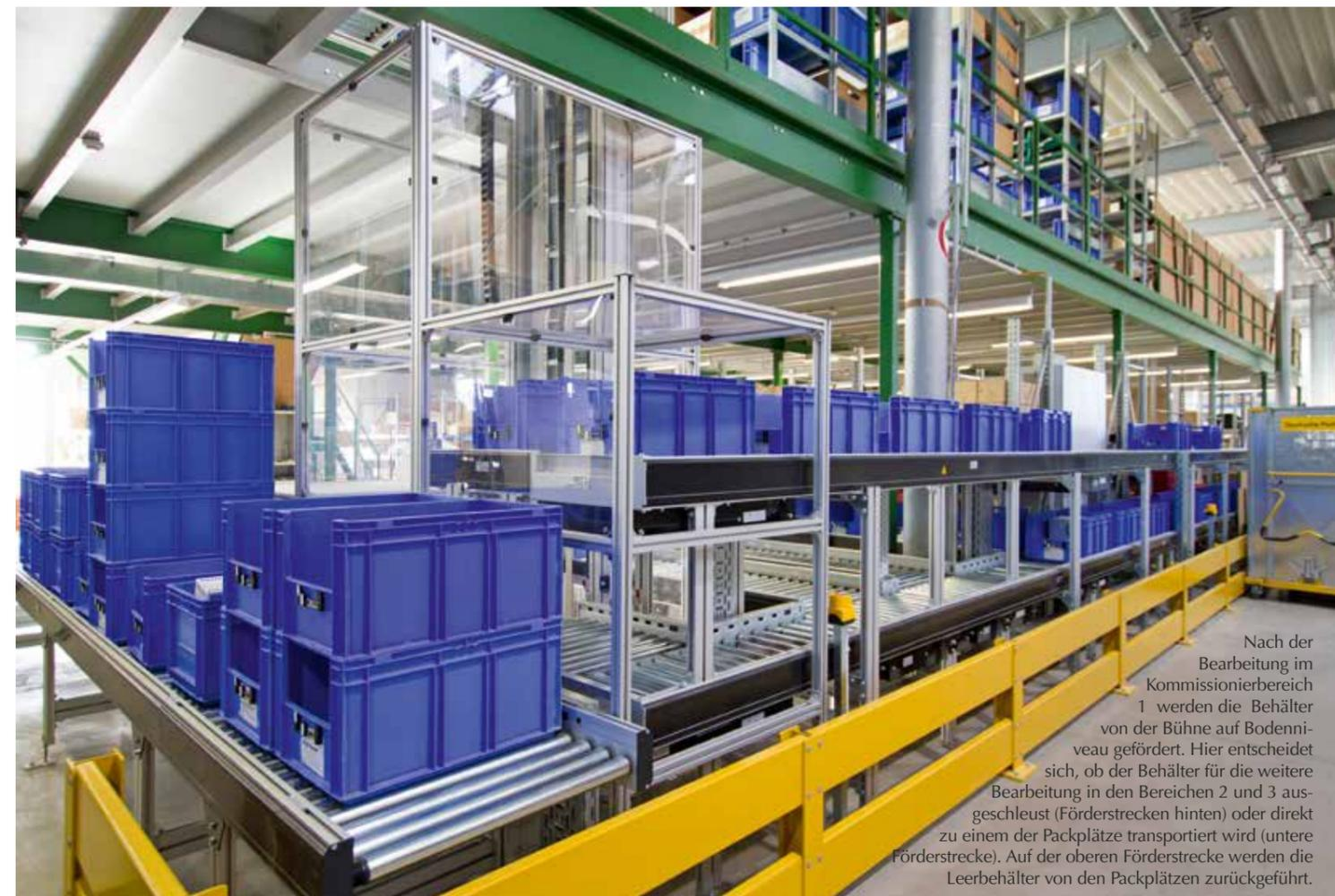
Nach der Bearbeitung im Kommissionierbereich 1 werden die Behälter von der Bühne auf Bodenniveau gefördert. Hier entscheidet sich, ob der Behälter für die weitere Bearbeitung in den Bereichen 2 und 3 ausgeschleust (Förderstrecken hinten) oder direkt zu einem der Packplätze transportiert wird (untere Förderstrecke). Auf der oberen Förderstrecke werden die Leerbehälter von den Packplätzen zurückgeführt.
