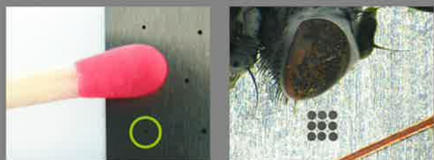
Microbohrungen in Hartmetall von \varnothing 0,08 mm bis \varnothing 6,00 mm
