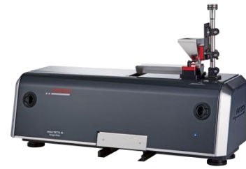
Abb. 3: ANALYSETTE 28 ImageSizer zur Trocken-Messung von Partikelform und -größe Pulvern und Schüttgütern
