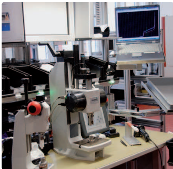
Fig. 3. Des presses manuelles avec et sans contrôle de la force et de la distance, assistées par un ordinateur et par l'outil de contrôle logiciel Schmidt.
