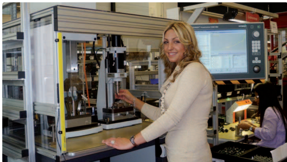
Fig. 4. Une installation hybride équipée d'une presse pneumatique et d'une servopresse. Chez Huba Control, l'ergonomie du poste de travail revêt une grande importance. (Photos: zvg)
