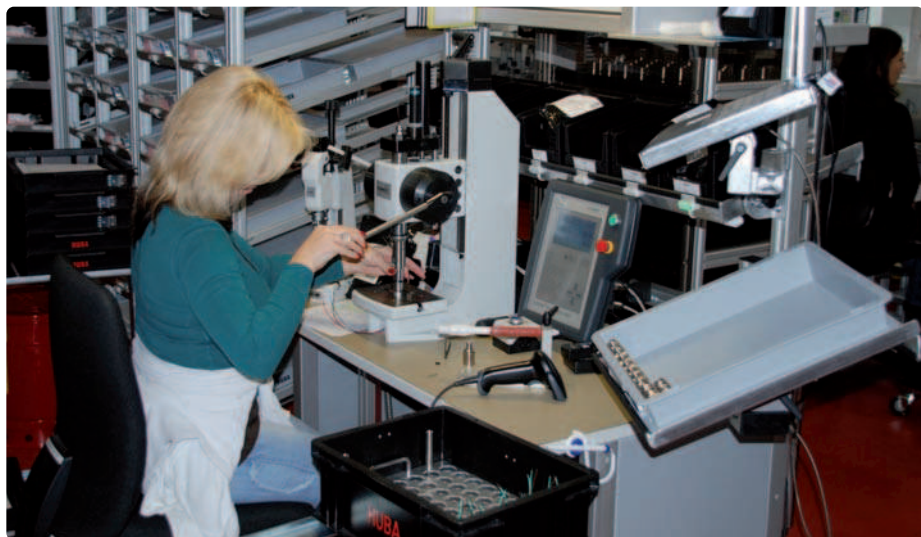
Fig. 2. Le contrôle de la force et de la distance, pour les presses manuelles aussi, assure la fiabilité des procédés d'assemblage, y compris pour des lots de petites dimensions.
