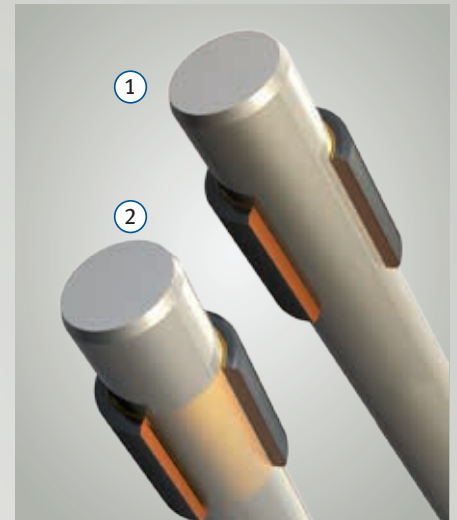
Abb. 3: Materialübertrag 1 Ausgangszustand 2 Ende Einlaufvorgang
