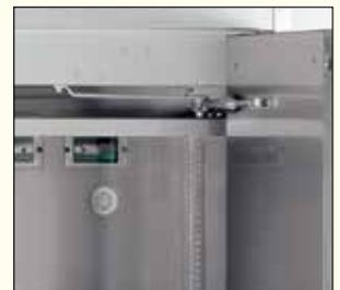
Türen mit serienmäßig integrierter Feststellanlage, Gebinde können so mit beiden Händen eingestellt und entnommen werden. Im Brandfall wird über Thermoelement automatisch die Türschließung eingeleitet.
