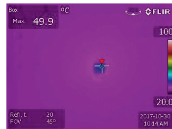
Bild 2: Bei Zimmertemperatur (+23 °C) zeigt der LTM8074 unter Last (12 V Eingangsspannung, 5 V Ausgangsspannung, 1 A Laststrom) nur eine geringe Erwärmung.
