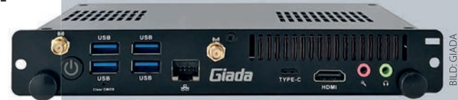
Der Giada PC610 passt in einen OPS-Slot.
