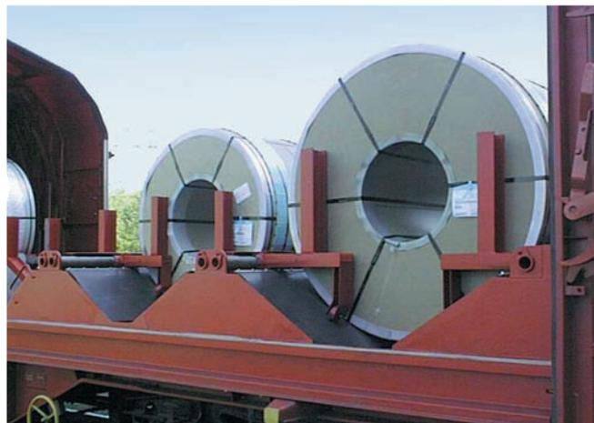
Abb. 16: Transport auf Waggon in Coilmulde; seitliche Sicherungsarme
