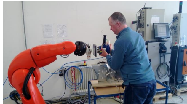
Bild 5: Vorbereitung der Kraft- und Druckmessung am Werkzeug eines kollaborierenden Robotersystems
