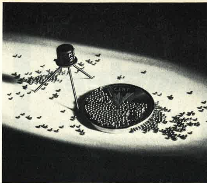
Bild 6: Löt­kü­gel­chen von 0,076 bis 1,79 mm Durch­mes­ser, die in jeder Stan­dard­lie­ge­rung ge­lie­fert wer­den könn­en, stell­te am kanadi­schen Ge­meinschafts­stand die Fir­ma Cramco Solder Alloys, Scarborough/Toronto aus Kennziffer 219
