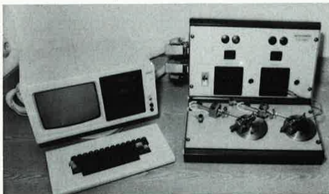
Dieser Potentiometerprüfstand meldet Fehlertrends in die Produktion zurück
