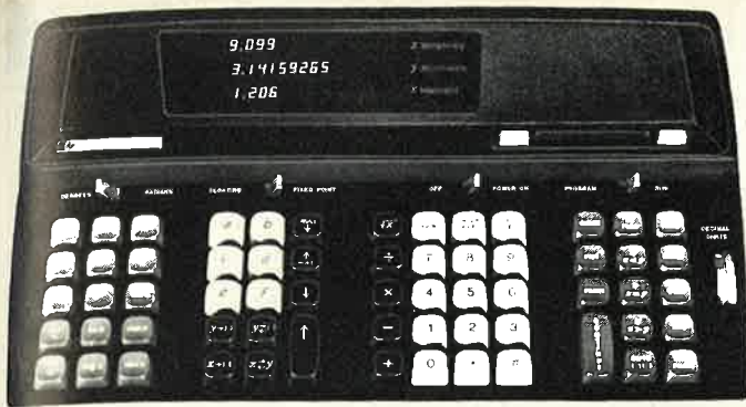
Bild 2: Tasten- und Anzeigefeld des Tischrechners 9100 A
