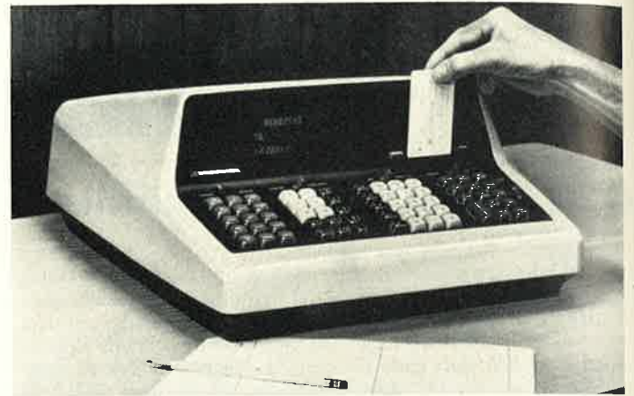
Bild 1: Tischrechner 9100 A; eingetastete Programme können für spätere Verwendung auf Magnetkarten gespeichert werden
