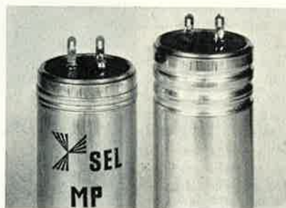
MP-Kondensator für 100 °C Grenztemperatur mit thermischer Überlastungssicherung; der linke Kondensator ist intakt, bei dem rechten wurde die Sicherung ausgelöst
