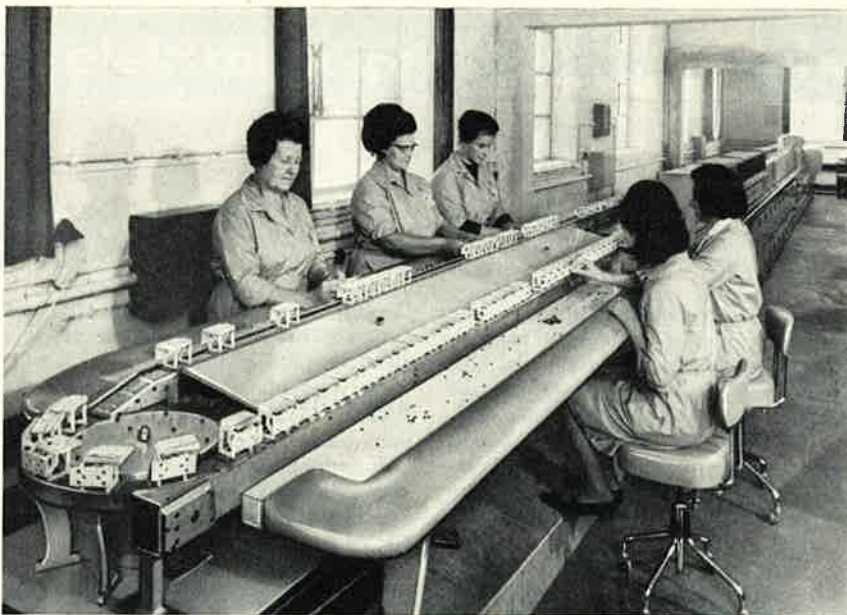
Bild 3: Die Silect-Plastiktransistoren werden in Keramikprüfslitten (Vordergrund) eingesteckt, mit denen sie dann die 54 Prüfstationen und die Klassierabteilung durchlaufen
