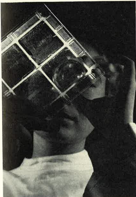
Speichermatrix in 2 1/2 -D-Flechtweise für 64 × 272 bit. Sie besteht aus 17 408 WTB-Kernen von 0,5 mm \phi (Siemens)
