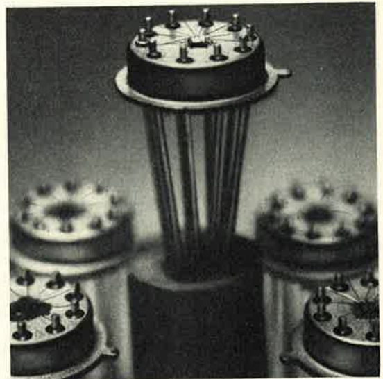
Im Vordergrund des Bauelementeangebotes stehen immer wieder die integrierten Schaltungen, die immer stärkeren Eingang in allen Zweigen der Industrie finden. Hier ein Schaltkreis in DT \mu L-Technik, Serie 945, im TO-5-Gehäuse (SGS-Fairchild)
