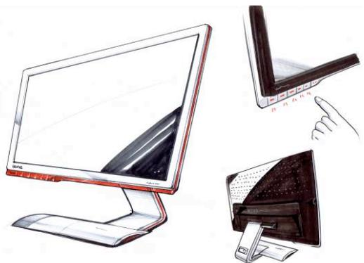
geplant. Obwohl der optische Eindruck entsteht, der Bildschirm könnte nach links kippen, ist er physikalisch jedoch absolut stabil. Durch die Verschiebung des Fußes wird die Belastung auf einen Punkt konzentriert. Dank der starken Spiralfeder sind alle Bauelemente exakt ausgesteuert, so dass der nach rechts verlagerte Fuß den gesamten Bildschirm sicher stützt. Durch die ausgeklügelte Metallkonstruktion des V2400W können individuelle Einstellungen und Justierungen problemlos
