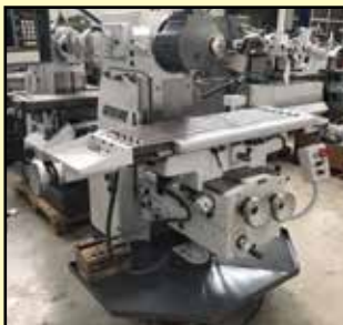
Reiden FU-150, Führungen neu eingeschabt, Spindeln revidiert. XYZ - 850, 250, 470, Drehzahl 45 bis 2000 U/min, Spindelauflaufnahme ISO 40. Weitere Infos zu der neuen SMM-Rubrik im Neu-, Lager- und Occasionsmaschinenmarkt: Tel 044 720 77 12, media@vogel-media.ch
