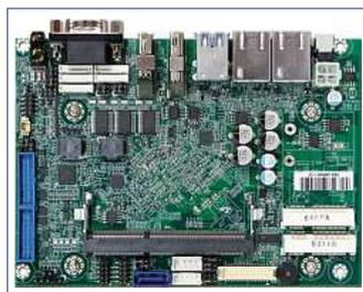
turbereich -40 °C bis 85 °C und der Eingangsspannungsbereich bei 12 V bis 24 V; bestens für robuste, lüfterlose Anwendungen.
