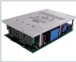
Die Hochleistungswandler der Serie LSR.Q von SYKO liefern eine nicht potenzialgetrennte, konstante Versorgungsspannung mit einer Leistung bis 500 W. Mit ihrem hohen Wirkungsgrad von bis zu 98%, ihrer weiten Eingangsspannungsbereiche, einer Umgebungstemperatur von -40 bis 70 °C, kurzzeitig sogar bis 85 °C, hoher Schock- und Vibrationsbelastbarkeit und einer geringen EMV-Belastung eignen sich diese Hochleistungswandler bestens für den Einsatz
