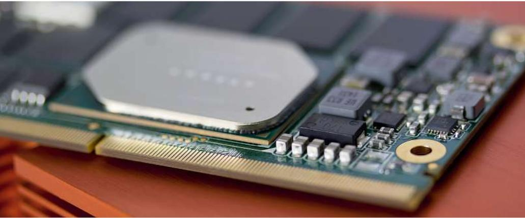
**Erweiterter Temperaturbereich:** Die neuen Intel-Atom-Prozessoren unterstützen Temperaturen von  $-40^{\circ}\text{C}$  bis  $85^{\circ}\text{C}$ , was neue Boards und Module zu einer idealen Vielzahl-Plattform für Designs in unterschiedlichsten Anwendungsbereichen macht.
