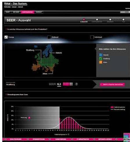
**Bild 2:** Der Energieeffizienz- und TCO-Rechner für Kühlgeräte mit Klimadiagramm entsprechend ausgewählter Klimazone und SEER.
