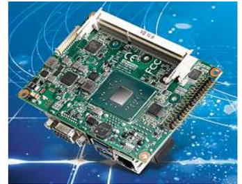
Die verschwindend geringen Verlustleistungen (TDP) ermöglichen eine passive Kühlung, was den Wartungsaufwand minimiert. Passend hierzu ist als Zubehör der MIO-2360 Heat Spreader verfügbar. Bis zu 8 GB Arbeitsspeicher (DDR3L 1867 MHz, Socket 1x 204-pin SODIMM) stehen Betriebssystem sowie Anwendungen zur Verfügung.
