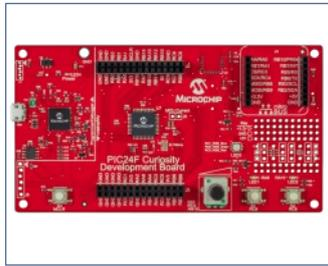
die externen Anschlüsse ermöglichen einen einzigartigen Zugriff auf die kernunabhängigen Peripheriekomponenten (CIPs). Diese CIPs erlauben dem Benutzer die Integration verschiedener Systemfunktionen auf einem einzigen Mikrocontroller, was das Design vereinfacht und Energieverbrauch sowie Materialkosten niedrig hält.
