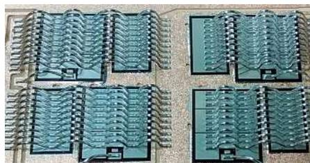
**Bild 5:** Optimiertes Chip- und DCB-Layout des HPDrive.
