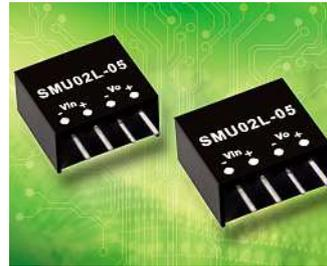
Die unregulierten DC/DC-Wandler der SMU02-Serie von Mean Well (Vertrieb: Emtron) liefern eine Ausgangsleistung von 2 W. Typ L ist für eine Eingangsspannung von 5 V<sub>DC</sub> ausgelegt, Typ M für 12 V<sub>DC</sub>, Typ N für 24 V<sub>DC</sub>. Alle Modelle akzeptieren Schwankungen der Eingangsspannung von bis zu ±10% und erfüllen gängige EMV-Anforderungen ohne weitere externe Beschaltung. Das SIP4-Gehäuse mit Standard-Pin-Belegung hat die Maße 11,6 mm x 7,5 mm x 10,14 mm.
