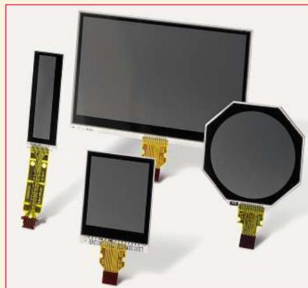
**Memory-in-Pixel-Technik:** Sie wird heute in Displays verschiedener Größe und Formate verwendet.
