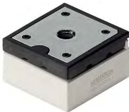
Bild 2: MiniSKiiP-Module sind für 600 V/650 V, 1200 V und 1700 V mit 4 bis 400 A Chip-Nennstrom konzipiert und bieten Trench-IGBT-Technologie in Verbindung mit den SEMIKRON-CAL-Dioden. 1200-V-Trench-IGBT4 und CAL4-Dioden sind für maximale Sperrschichttemperaturen von 175 °C vorgesehen.
