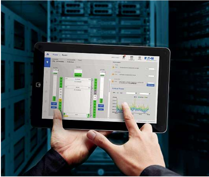
Bild 4: Der Intelligent Power Manager (IPM) ist eine Infrastruktur-Software, mit der die Leistung von Rechenzentren sowie die Umwelt- und physischen Kapazitätskennzahlen innerhalb der IT-Infrastruktur überwacht werden.
