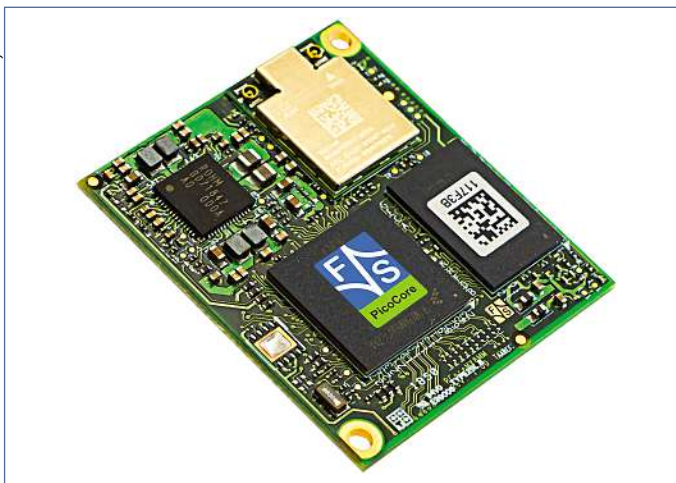
PicoCoreMX8MM: lediglich 35 mm x 40 mm misst das Modul im PicoCore-Standard. Dennoch bietet es zahlreiche Industrieschnittstellen.
