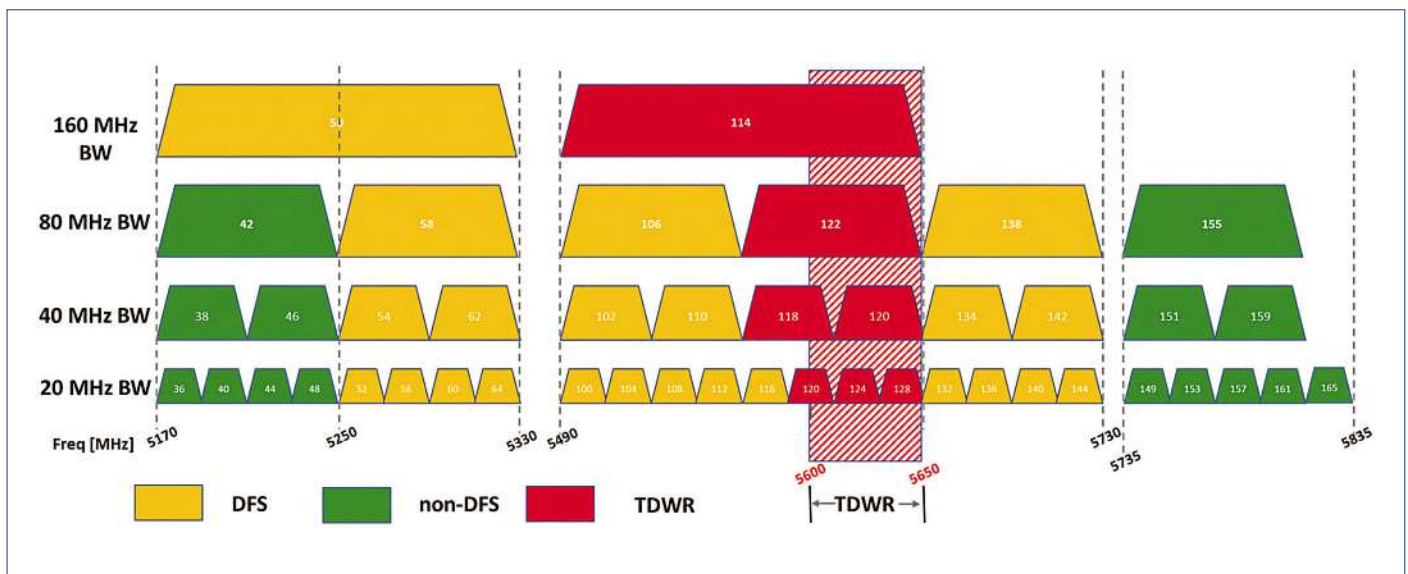
Bild 1: Im 5-GHz-Frequenzspektrum nach IEEE 802.11 haben Radar-Anwendungen im Bereich zwischen 5600 und 5650 MHz Vorfahrt. Sobald ein Radarsignal erkannt wird, müssen alle anderen Nutzer das TDWR-Band verlassen.
