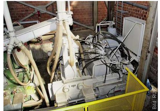
Die RUF-Pressen werden über ein Rohrsystem und eine Förderschnecke mit dem angefallenen PUR-Staub beschickt, der dort zu leicht transportierbaren, kompakten Briketts verarbeitet wird.
