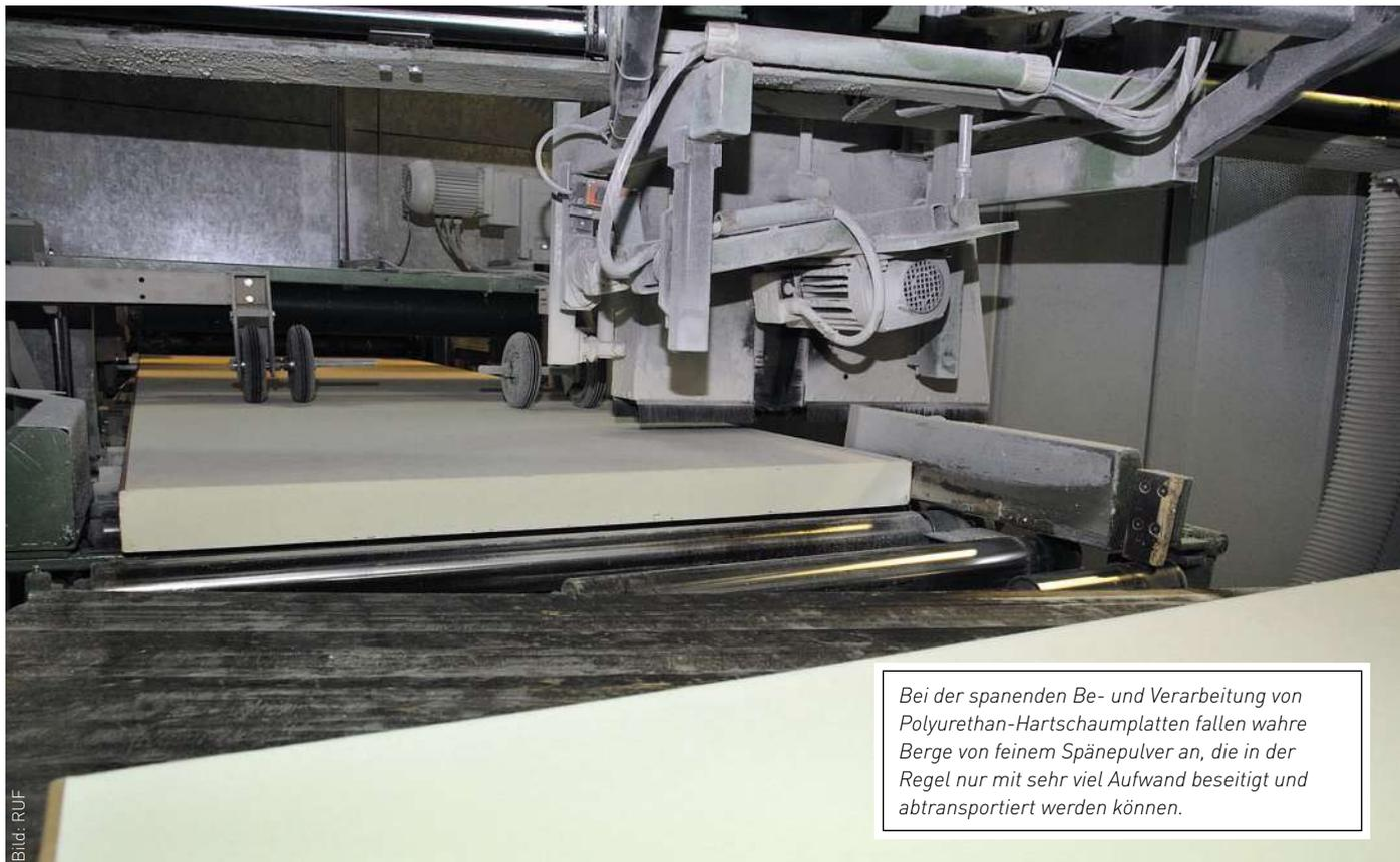
Bei der spanenden Be- und Verarbeitung von Polyurethan-Hartschaumplatten fallen wahre Berge von feinem Spänepulver an, die in der Regel nur mit sehr viel Aufwand beseitigt und abtransportiert werden können.
